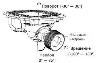
Рисунок 1-23 Настройка угла наблюдения камеры
