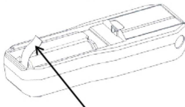
2. Откройте крышку батарейного отсека на задней стороне устройства и вытащите использованные батарейки. Установите новые батарейки типа AAA , как показано на инструкции ниже.
